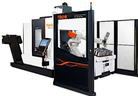
Die Mazak CV5-500 kann in eine schlüsselfertige 5-Achsen-Automationslösung eingebunden und beispielsweise mit einem MA-Roboter zum Laden und Entladen der Werkstücke kombiniert werden.
