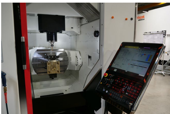
Bearbeitung des Gehäuses einer Druckminderstation. Der Schwenkrundtisch erlaubt die Bearbeitung von allen Seiten
