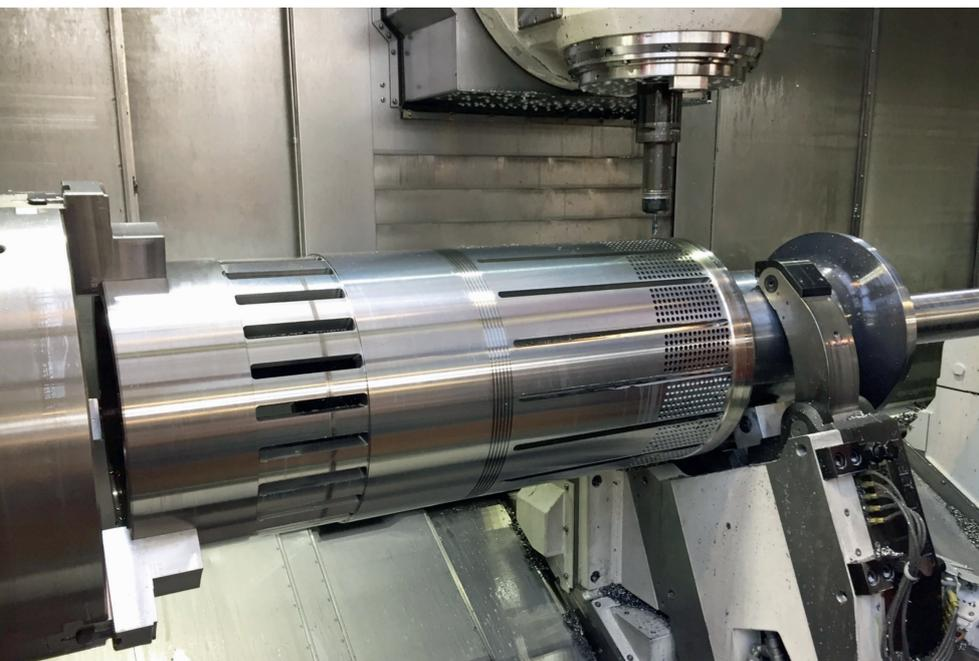
1 Auf der Komplettbearbeitungsmaschine Mazak Integrex e-500H II bearbeitet Pruss zahlreiche komplexe Großteile weitgehend in einer Aufspannung (© Mazak)
