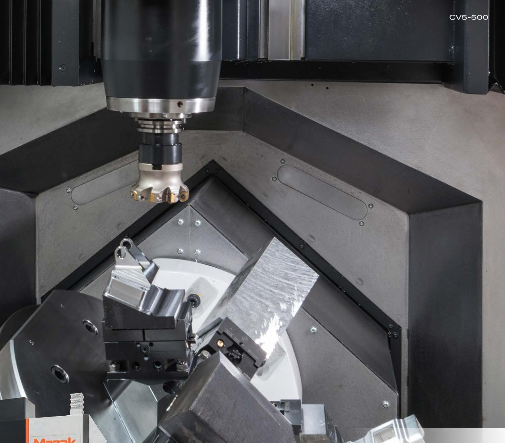
Kompaktes 5-Achsen-Präzisionsbearbeitungszentrum in Vertikalausführung
